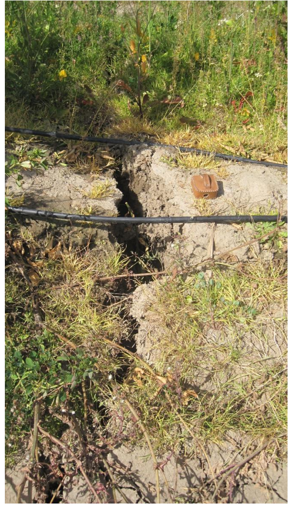
Şekil 54 a-b: Adalı (Karataş-Adana) mahallesi doğu kesimlerinde Ceyhan Nehri kenarında alüvyon zemin üzerinde Narenciye bahçesi üzerinde Ceyhan Nehrinin akış yönüne paralel (K20-30 B yönlü) şekilde gelişen yarılmalar
