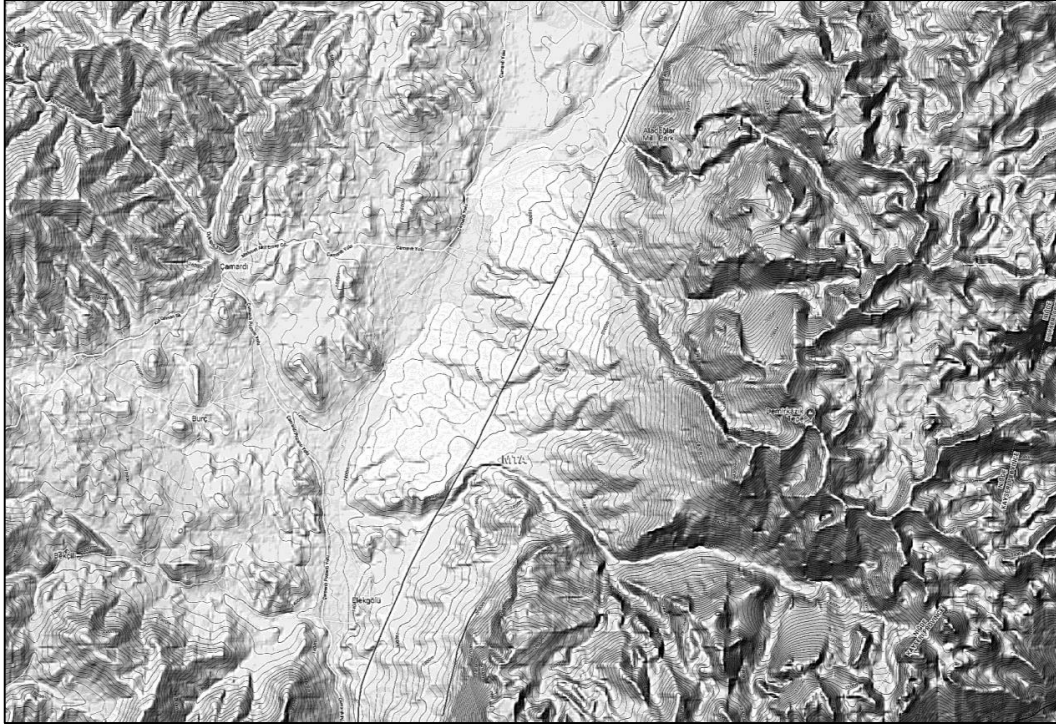
Şekil 16. Ecemiş Fayı'nın uzanımının izohips yükselti haritası üzerinde görünümü. Fay boyunca morfolojik yapıların kesilmesi ve ani değişimi dikkat çekmektedir (Ünlügenç ve Akıncı, 2019).
