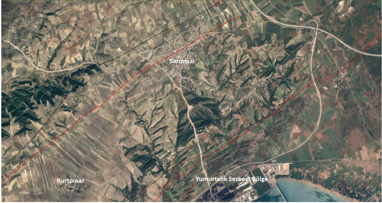
Şekil 14. Ceyhan-Karataş (kuzeyde) ve Yumurtalık fay hatlarının (güneyde) İskenderun Körfezi kuzeyinden geçtikleri bölgenin uydu fotoğrafı üzerinden görünümü.
