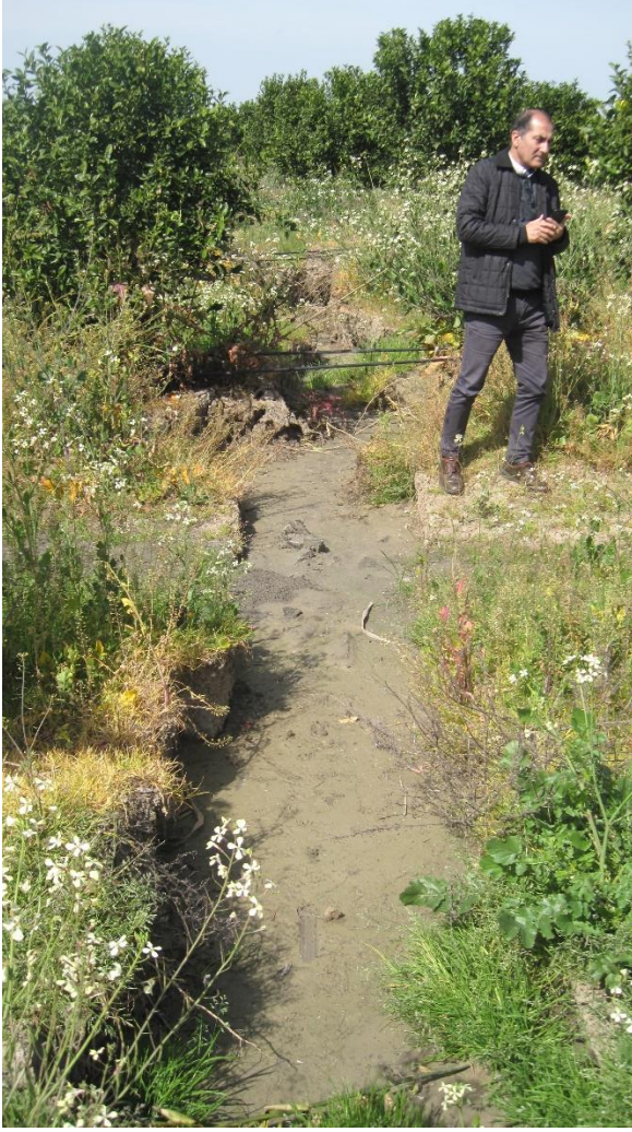
Şekil 54 a-b: Adalı (Karataş-Adana) mahallesi doğu kesimlerinde Ceyhan Nehri kenarında alüvyon zemin üzerinde Narenciye bahçesi üzerinde Ceyhan Nehrinin akış yönüne paralel (K20-30 B yönlü) şekilde gelişen yarılmalar
