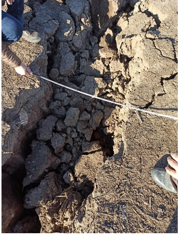
Şekil 37. Beyoğlu, Yeni Mahalle civarında (Kahramanmaraş) DAF zonu üzerinde yaklaşık Dere kenarında yolun bentleşmesi (Su borusu bükülmüş) ve hemen yolun yan tarafında da meydana gelen 77 cm lik kırık oluşumu.
